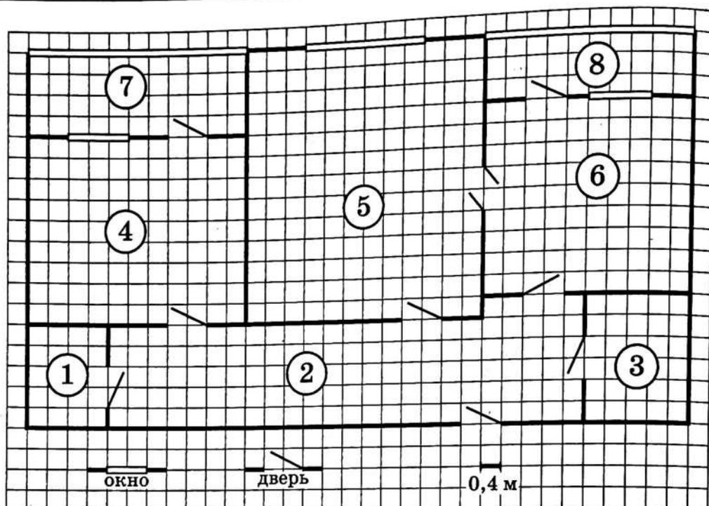
На рисунке изображён план двухкомнатной квартиры в многоэтажном жилом доме. Внизу рисунка даны обозначения окна и двери, а также указано, что длина стороны клетки на плане соответствует 0,4 м. Вход в квартиру находится в прихожей. В квартире есть две застеклённые лоджии: меньшая из них примыкает к кухне, большая — к спальне. На улицу также выходит окно гостиной. Кроме указанных помещений в квартире есть ещё санузел и кладовая, причём площадь санузла больше площади кладовой.
