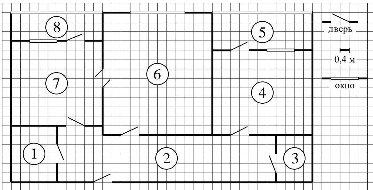
На рисунке изображён план двухкомнатной квартиры в многоэтажном жилом доме. Сторона одной клетки на плане соответствует 0,4 м, а условные обозначения двери и окна приведены в правой части рисунка.
