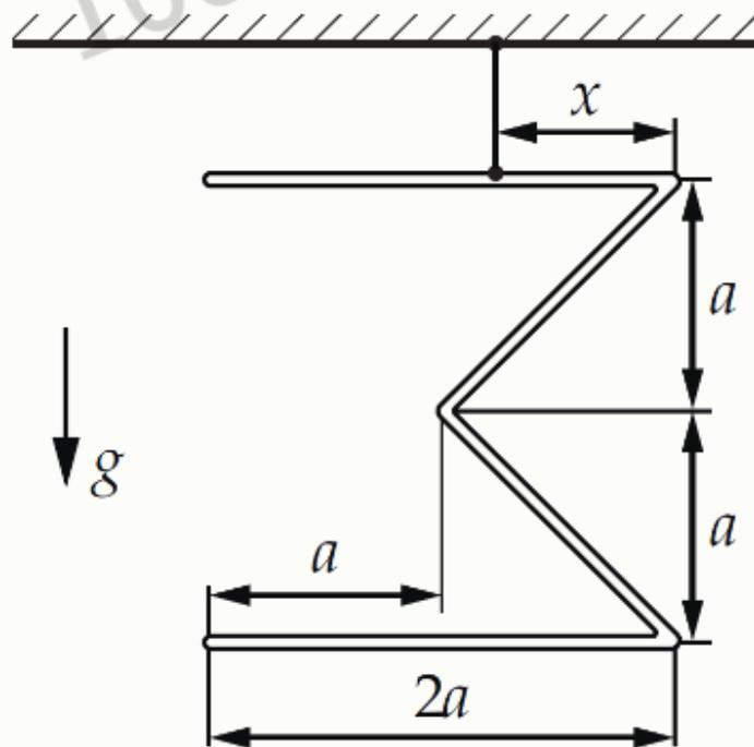
Определите длину проволоки  $L$ , из которой изготовлена фигура, если её можно уравновесить на тонкой нитке, закреплённой на расстоянии  $x = 5$  см от края фигуры. В ответе к задаче укажите номер столбца таблицы, в котором стоит значение, наиболее близкое к найденному вами.
