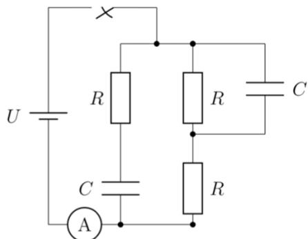
**17.** Найдите показание амперметра сразу после замыкания ключа.
