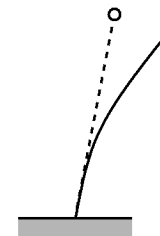
Рисунок 1. Криволинейное распространение светового луча в атмосфере (сплошная линия) и кажущееся смещение объекта (пунктирная линия)
