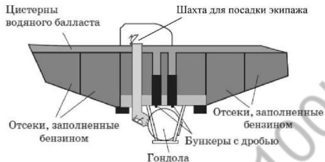
Рисунок 2. Схема батискафа
