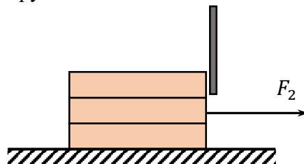
3) Нижний брускок можно вытащить из стопки резко ударив по нему. Так и сделали, сообщив ему начальную скорость  $v_0 = 3 \text{ м/с}$ , как показано на рисунке. В момент падения верхних брусков на стол нижний брускок имеет скорость  $1 \text{ м/с}$ . С какой скоростью движутся в этот момент два остальных бруска? Ответ выразите в м/с, округлите до десятых.
