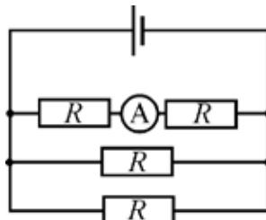
11) Напряжение на всех параллельных участках равно напряжению на батарее, т.е. для участка, включающего два резистора и амперметр, согласно закону Ома, имеем:  $I = \frac{U}{2R} = 1,5 \text{ мА}$ .
