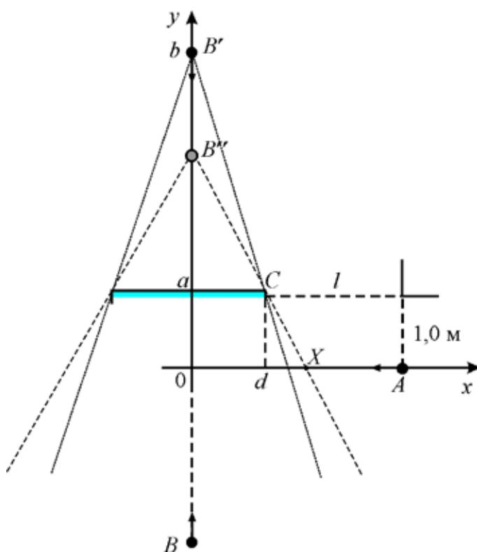
Координату точки  $x$  определим из подобия треугольников  $BOX$  и  $BXC$  получаем:  $\frac{b - V_B t + a}{X} = \frac{b - V_B t}{d/2}$ , откуда  $X = \frac{b - V_B t + a}{b - V_B t} d / 2$ .
